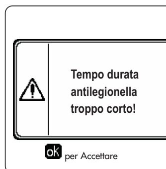
fig. 28 - Messaggio Funzione antilegionella non conclusa
